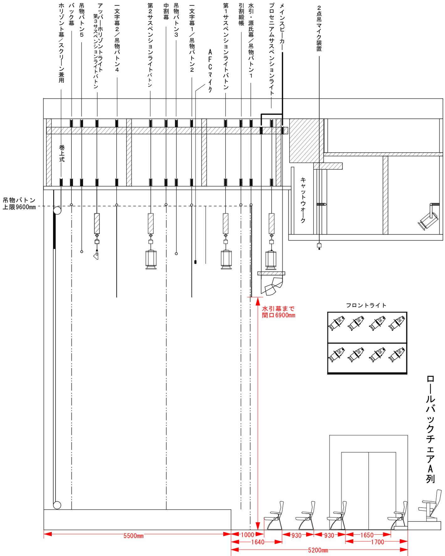
スカイタウンホール断面図（置き椅子設置図）
